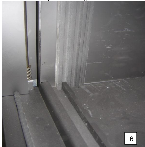
Montage des Spoilers links
