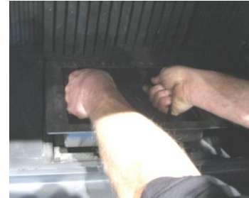
Heben Sie die Aschenlade an der Vorderseite auf und dann nach oben. Zur Positionierung des Aschekastens im Kamin muss dessen Rückseite zunächst unter die Stützlappen geschoben werden, bevor der Kasten auf die Stützbügel gelegt werden kann.
