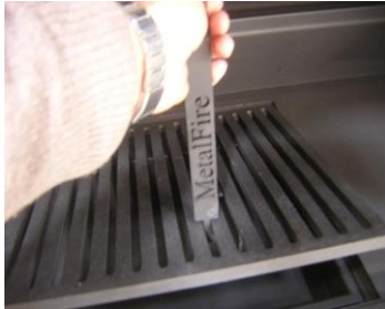
Stecken Sie den Hebel in den Rost
